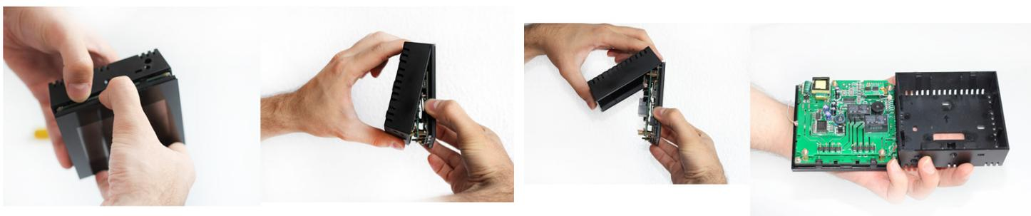
Extraiga la parte trasera de la carcasa. Ahí verá marcadas las posiciones que ocupan los cables de su instalación de calefacción o/y aire acondicionado. También verá varias aberturas en las que, posteriormente, estarán las fijaciones del termostato a la pared.
