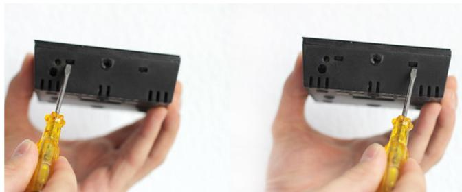
Presione las aberturas suavemente haciendo palanca. Efectúe un movimiento de bisagra para terminar de abrir la carcasa del termostato sin forzar los pines de conexión.
